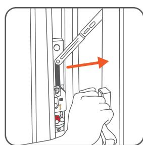
打開推開窗，開口限制器啟動
