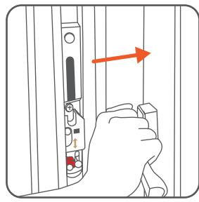
打開推開窗，開口限制器關閉，推開窗內扇可以開啟到最大
